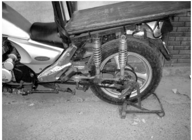
図5 大きな荷台を設置し、重い積載に耐えられるようサスペンションとダンパーを増設。車体を垂直に保つことができるスタンドも増設する改造が施される。(2005年12月ソウル市黒石洞にて撮影)
